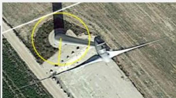
Si cependant, une étude démontre que malgré la longueur de pale de 61m et la distance de 132m, l'éolienne impacte toujours le faisceau hertzien, le maître d'ouvrage posera un porté à connaissance sur l'éolienne E5 pour un gabarit de machine avec une pale de 50m maximum respectant alors la distance de 105 mètres préconisée.
